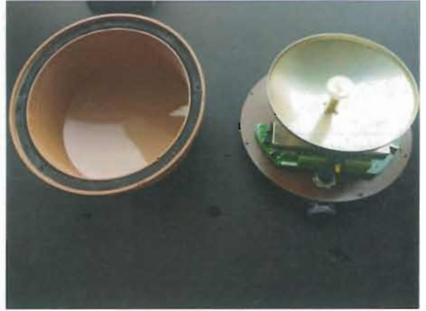
图 25: 防水试验后内部情况
