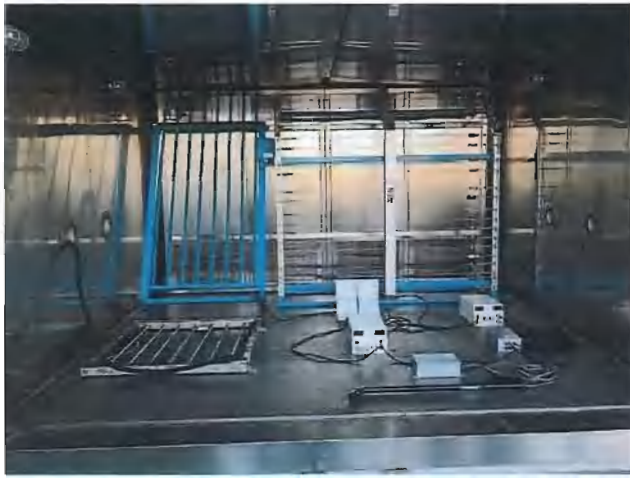
图 1: 高低温、低温贮存、恒定湿热试验照片
