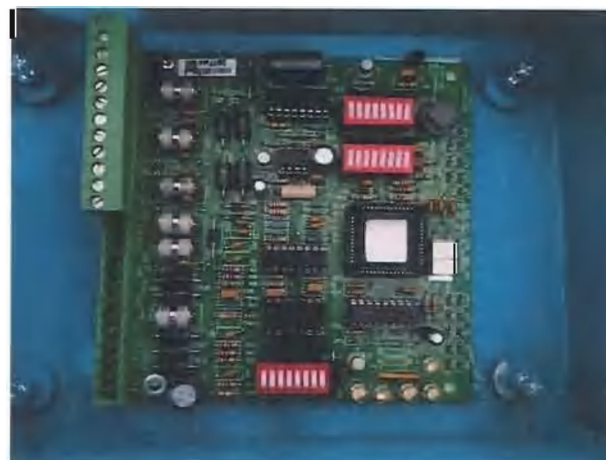
图 12: 防尘试验后内部情况
