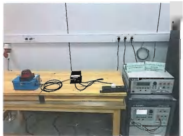
图 23: 浪涌冲击抗扰度试验照片
