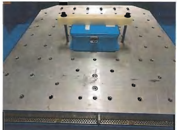
图 6: 振动、冲击试验照片（横向）
