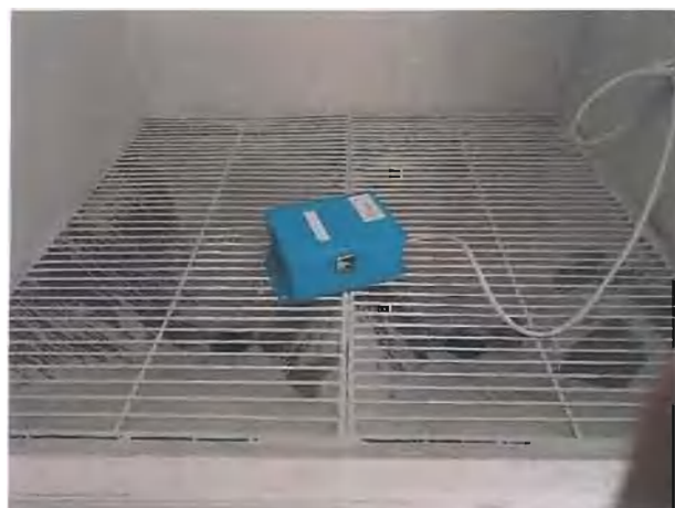
图 11: 防尘试验照片
