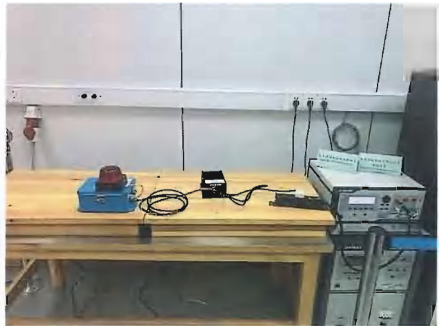
图 21: 电快速瞬变脉冲群抗扰度试验照片
