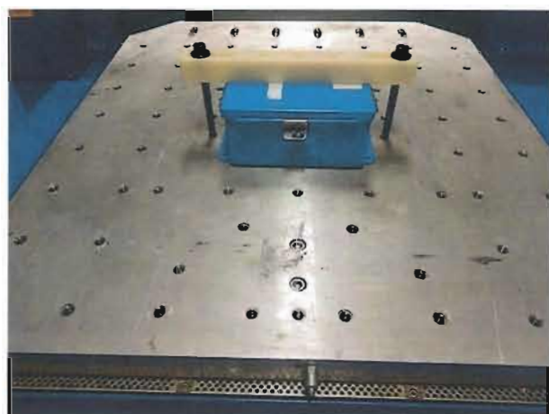
图 6: 振动、冲击试验照片（横向）
