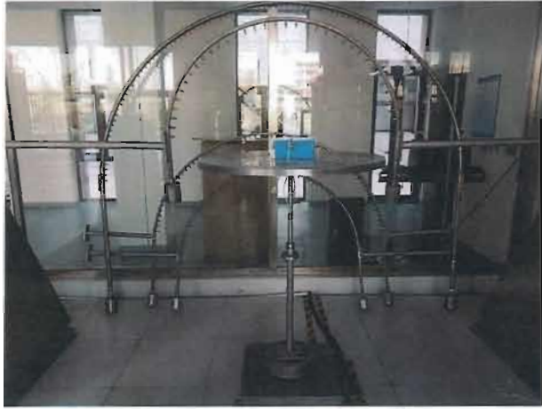
图 13: 防水试验照片
