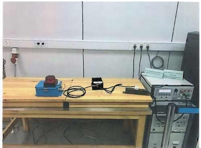
图 21: 电快速瞬变脉冲群抗扰度试验照片
