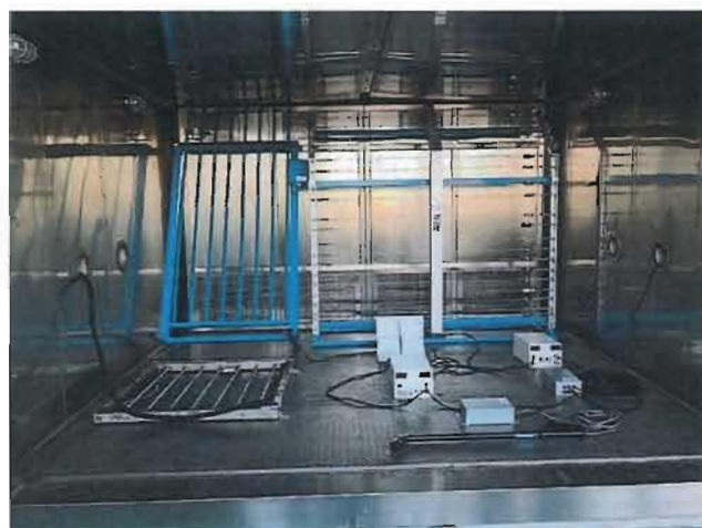
图 1: 高低温、低温贮存、恒定湿热试验照片
