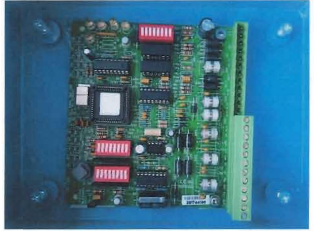
图 14: 防水试验后内部情况
