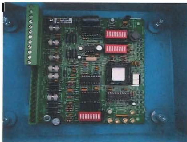
图 12: 防尘试验后内部情况
