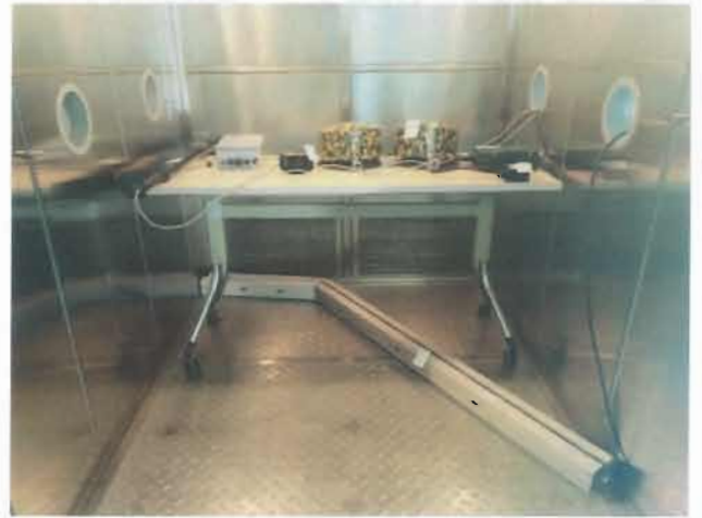
图 2、高低温、低温贮存、恒定湿热试验照片 (下层为样品)
